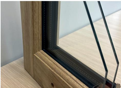
UN JOINT EXTRUDÉ autocollant en caoutchouc alvéolaire EPDM comprimé permet la pose à sec du vitrage isolant. Ce joint assure la barrière principale d'étanchéité à l'eau et à l'air.
